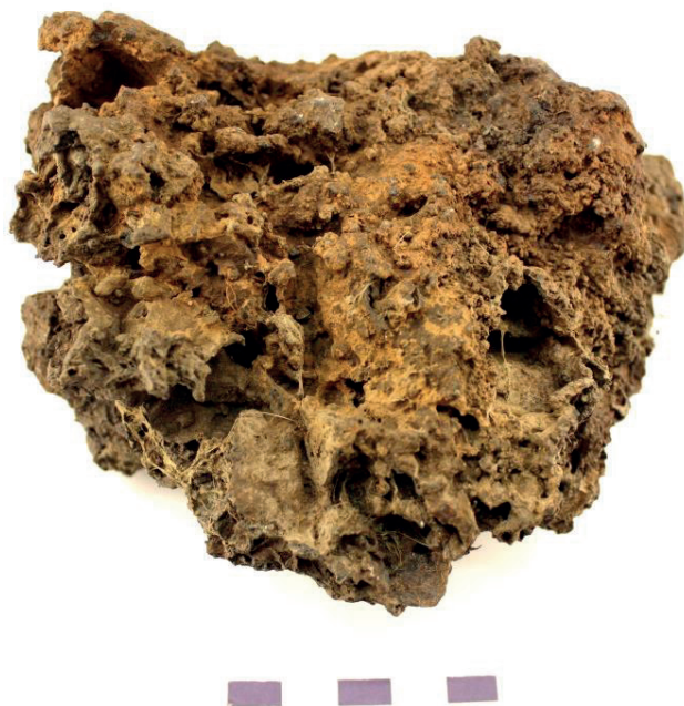
Figur 6. Exempel på trögfluten slagg med rostbrun yta som ställvis är magnetisk.
