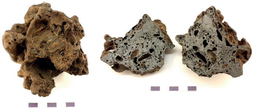
Figur 8. Slagg som har stelnat runt kolstycken som lämnat tydliga avtryck, Till höger i delat tvärsnitt. Inget bevarat kol har dock observerats. Slaggen är homogen i sin sammansättning, med varierande mängd och storlek på hålrum.
