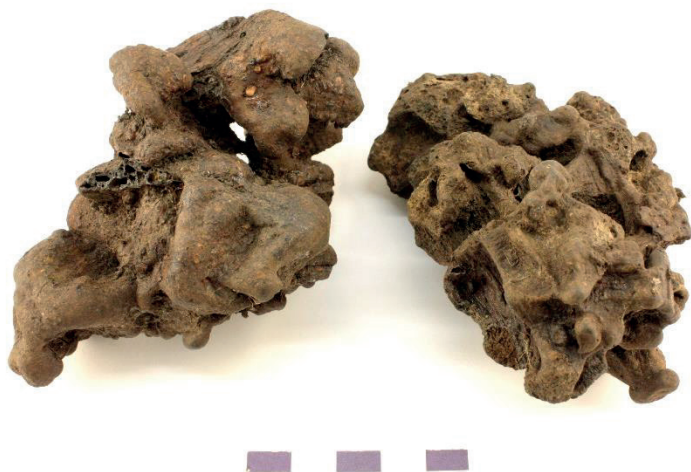
Figur 7. Slaggar som är uppbyggda av flera slagglöden.
