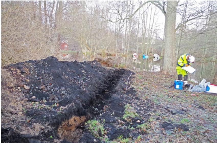
Figur 15. Schakt 4 togs upp inom en yta där man fyllt ut strandområdet med slagg och avfall från glasbruket. Närmast till vänster syns övergången mot den ljusare, ursprungliga marken. Foto från söder.
