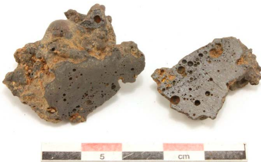
Figur 7. Prov RM efter delning med såg. Det högra stycket preparerades till tunnslip medan resten (vänstra biten) analyserades totalkemiskt. Notera att den grå slagmassan är tät och förhållandevis fattig på porer (jämför fig. 5 & 6).
