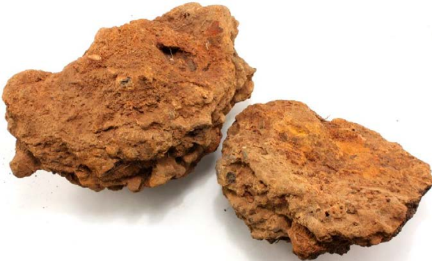
Figur 2. Slagg I där den högra biten utvaldes för preparering till prov (RI) för analyser i mikroskop (tunnslip) samt totalkemi. Jämför fig. 6.
