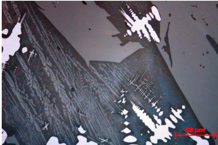
Figur 11. I mycket hög förstoring ses att den ljusa wüstiten växer dendritiskt även i mycket liten skala. De stora grå olivinkristallerna uppvisar inte någon zonerings och olivinen ses även dominera den mörka mellanliggande glasfasen, fast då i betydligt mindre kristallstorlek.
