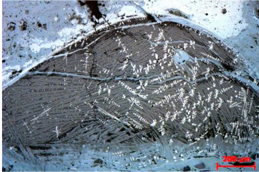
Figur 21. Slagg i järn RL, här helt omgivet av grå-blå rost.
