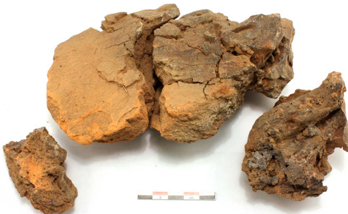
Figur 45: Ugnsvägg från slagvarpet A2397. Lerväggarna var jämnt brända på utsidan men delvis smälta och förglasade på insidan. Foto GAL.
