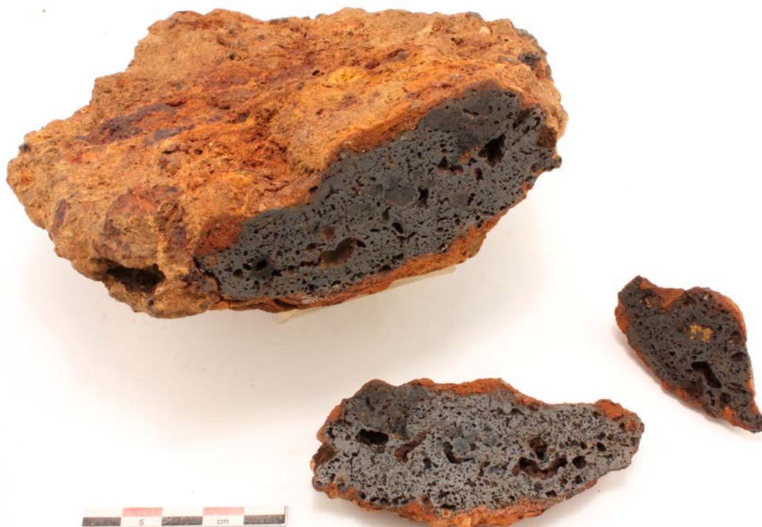
Figur 46: Analyserna visade att slaggerna stelnat inne i ugnen eller i en uppsamlingsgrop under. Den för järnåldern typiska stearinformade slaggen saknades dock i fyndmaterialet. Foto GAL.
