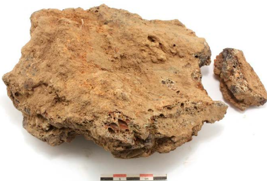
Figur 34. Teknisk keramik fynd K. Konkav insida med slagg.
