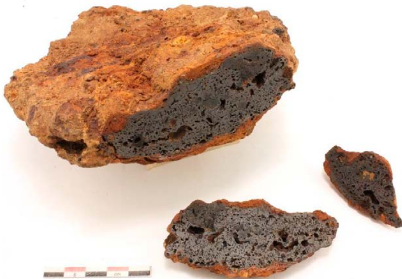
Figur 6. Prov RI efter delning med såg. Det högra stycket preparerades till tunnslip medan mittbiten analyserades totalkemiskt. Noterbart är att slaggen har ovanligt små porer och att formen (även i tvärsnittet) är plan-konvex.
