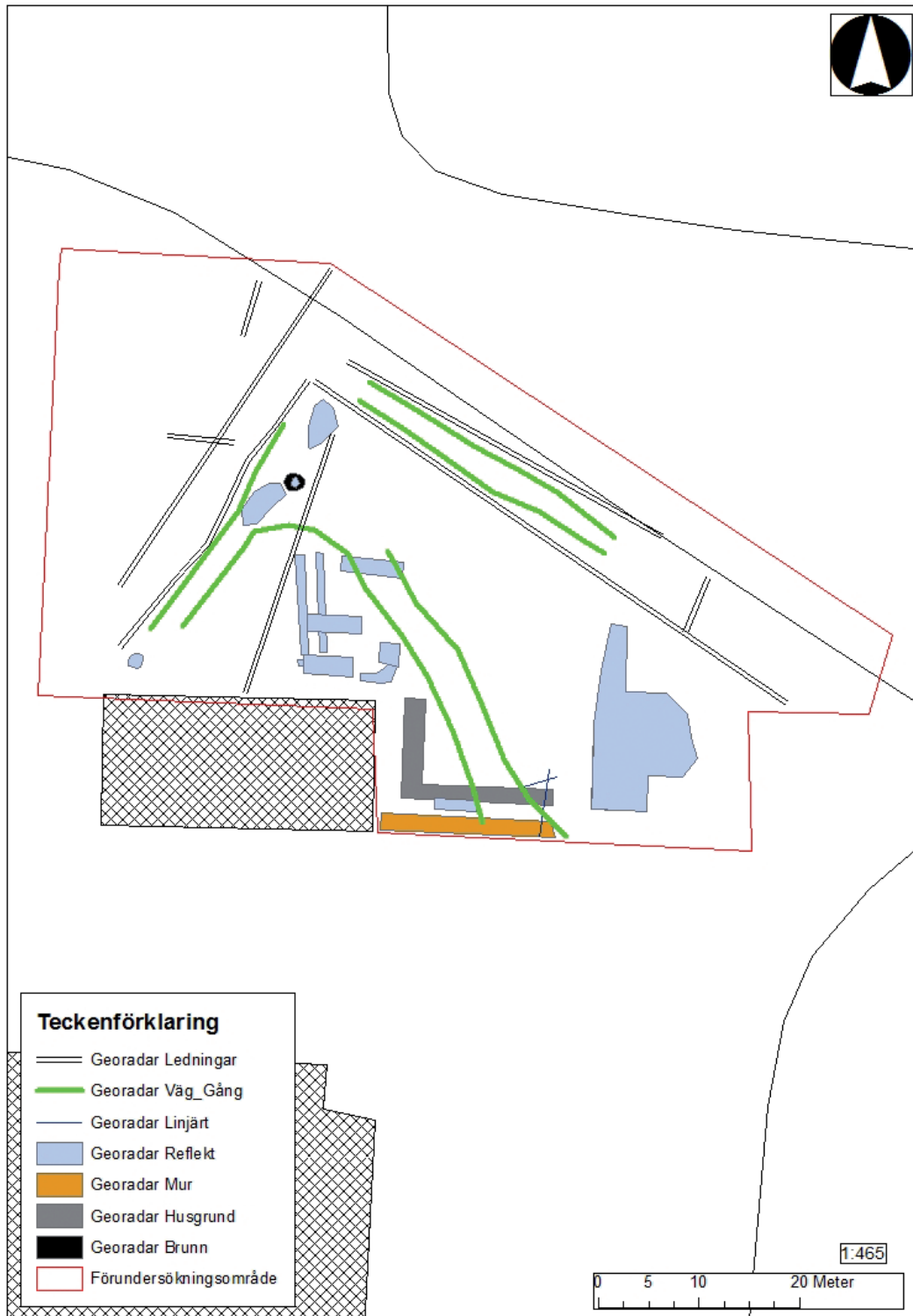
Fig. 26: Georadarundersökningen gav viktig bakgrundskunskap inför schaktgrävningen. Plan med några georadarindikationer inom förundersökningsområdet. Vissa av tolkningarna besannades, andra inte.
