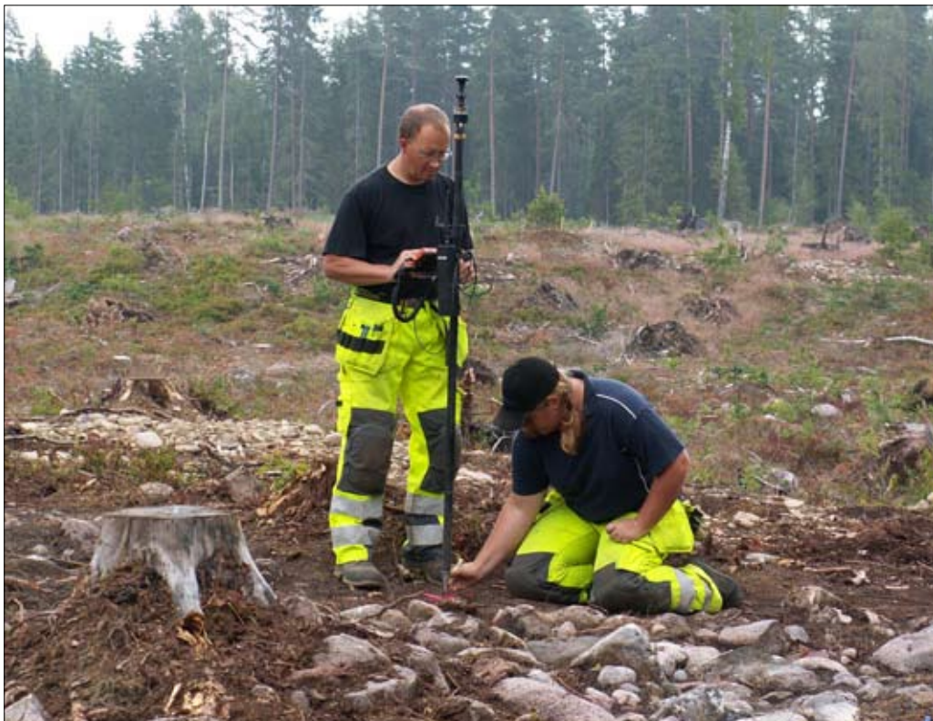
Figur 7. Inmätning med hjälp av totalstation. Nicholas Nilsson och Veronica Palm.
