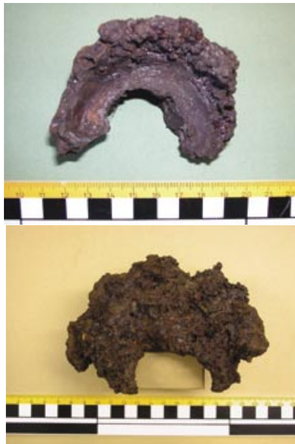
Fig 97-98. Cylindriska avtryck av blästerrör i järnhaltig slagg, F500772 och 500756. Foto GAL.
