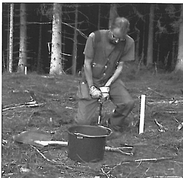
Fig 5. Jordprovstagning för fosfatanalys. (Foto: Inger Torstensdotter Åhlin)
